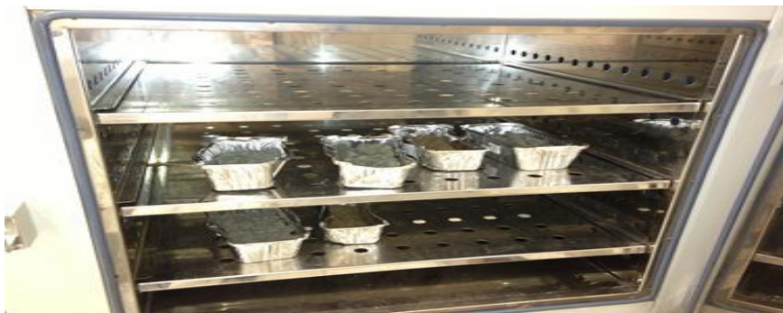
Figure 7 : Séchage du sol à l'étuve (40 °C)
